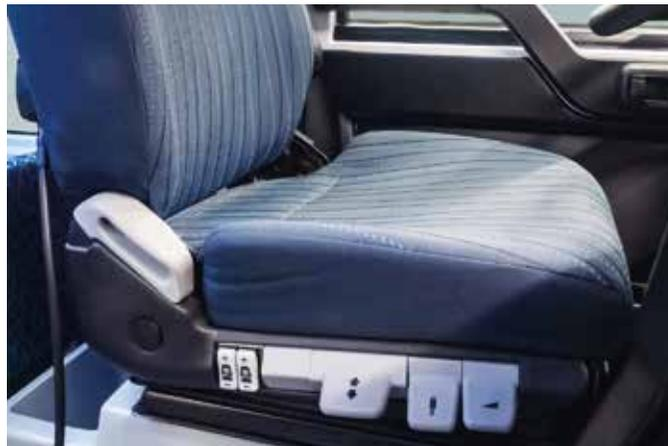
8- Fach Verstellbarer Pneumatischgefederter Fahrersitz
