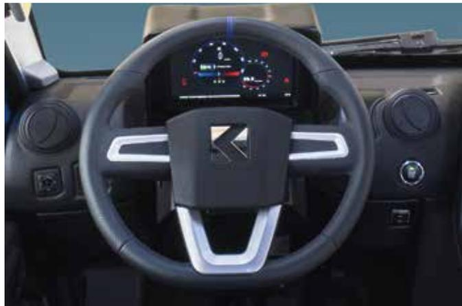
Höhen- & Neigungsverstellbares Elektrohydraulisches Lenkrad
